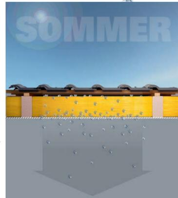
Die variable Membran der ALUJET Climajet SD VARIO ist im Sommer weit geöffnet, sodass Feuchtigkeit aus der Konstruktion problemlos in den Raum diffundieren kann. Das gesamte Bauteil kann nach innen austrocknen und wird dadurch nachhaltig geschützt.
