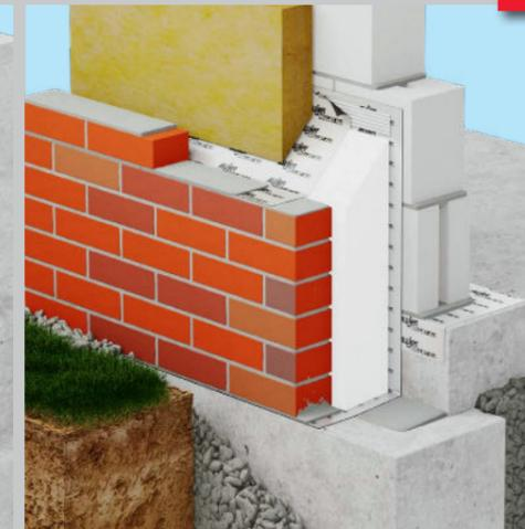
Im zweischaligen Mauerwerk auf Streifenfundament
