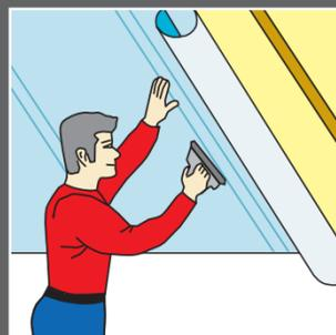
Verlegung und antackern der Dampfsperrbahn
