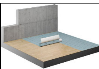
Abb. 5: Ausrollen der Bahn – und Abziehen des Schutzliners
