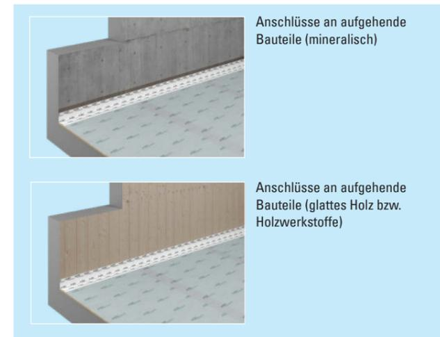
Anschlüsse an aufgehende Bauteile (mineralisch)
